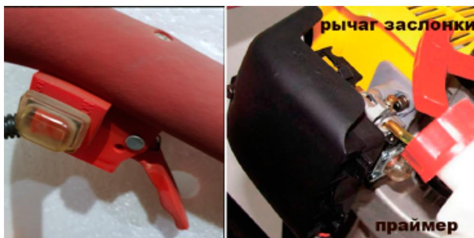
1. Для включения зажигания переведите кнопку включения зажигания в положение ON ( включено ).
